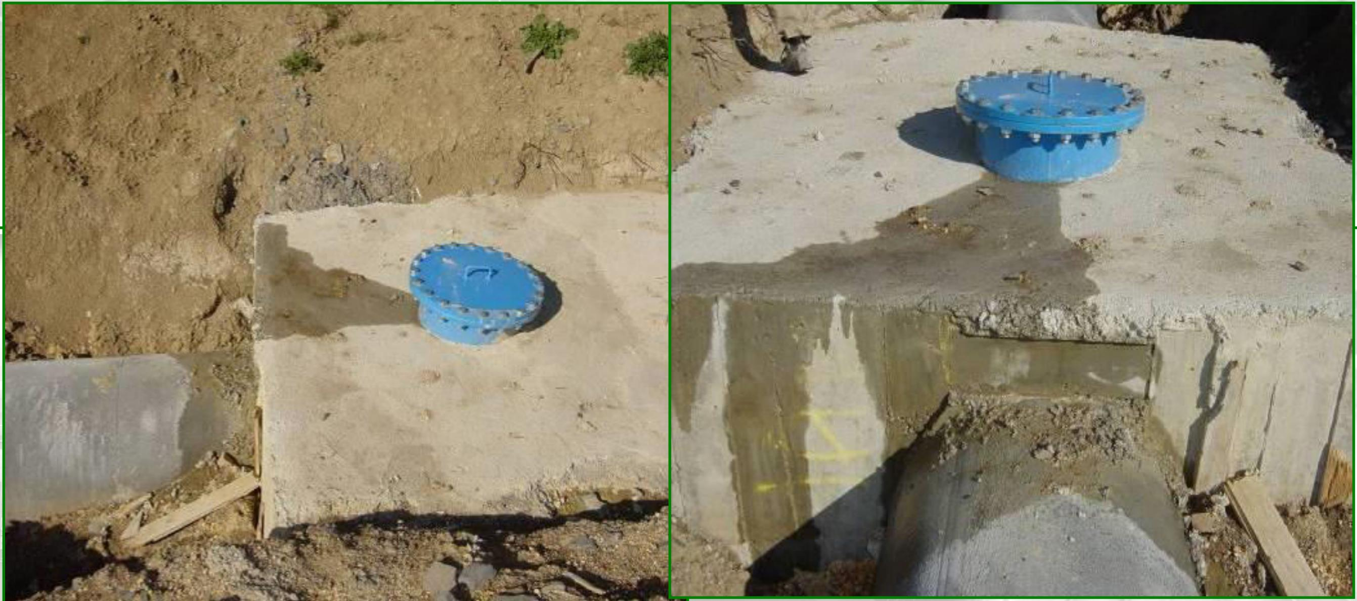
**Fuga en una soldadura de una pieza especial, detectada el día de la prueba de presión.**
